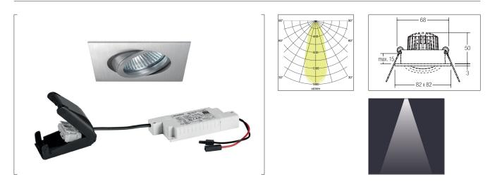
LED-Einbaustrahlerset, dim2warm, Phasenabschnitt dimmbar,mit Anschlussbox, alu matt, quadratisch. Ausgeführt in kompakter Bauform für werkzeuglose Schnellmontage zum Deckeneinbau. Wird die Leuchte gedimmt, verringert sich die Farbtemperatur.
