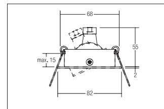
Einbaustrahler, V4A, GX5,3, edelstahl, rund. Ausgeführt in kompakter Bauform für werkzeuglose Schnellmontage zum Decken-einbauAusführung: GX5,3, Montageart: Einbaumontage, Montageort: Deckenmontage, Material: Edelstahl V4A, Schutzart: nach DIN EN 60529: IP20, Schutzklasse: (EN 61140) III, Spannung: 12V, Leistung: 50W, Anzahl der Leuchtmittel / Fassungen: 1.0 Stk, Verstellbarkeit: schwenkbar, ohne Betriebsgerät, Art der Dimmung: abhängig vom Betriebsgerät .
