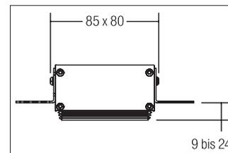
Einputzrahmen COUPLED, quadratisch, für rahmenlosen Einbau, weiß, rechteckig. Ausgeführt in kompakter Bauform für werkzeuglose Schnellmontage zum Deckeneinbau. Einputzrahmen für Deckeneinbauleuchten COUPLED als Basis für 12640/12645, 12642/12644 und 12641/12643
