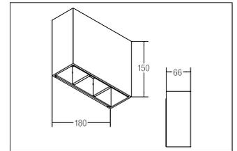
LED-Wandanbauleuchte, IP54, strukturgraphit, rechteckig. Ausführung in kompakter Bauform für die harmonische Implementierung in stimmige, architektonische Raumkonzepte. Lichtaustritt direkt und indirekt.
