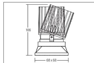
LED-System-Einbaustrahler, vertieft, dim2warm, weiß, quadratisch. Ausgeführt in kompakter Bauform für werkzeuglose Schnellmontage zum Deckeneinbau. Wird die Leuchte gedimmt, verringert sich die Farbtemperatur.
