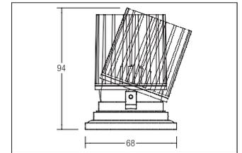
LED-System-Einbaustrahler, weiß, rund. Ausgeführt in kompakter Bauform für werkzeuglose Schnellmontage zum Deckeneinbau. Montage nur zzgl. Einputz- oder Einbaurahmen 82030170 oder 82032170 möglich.
