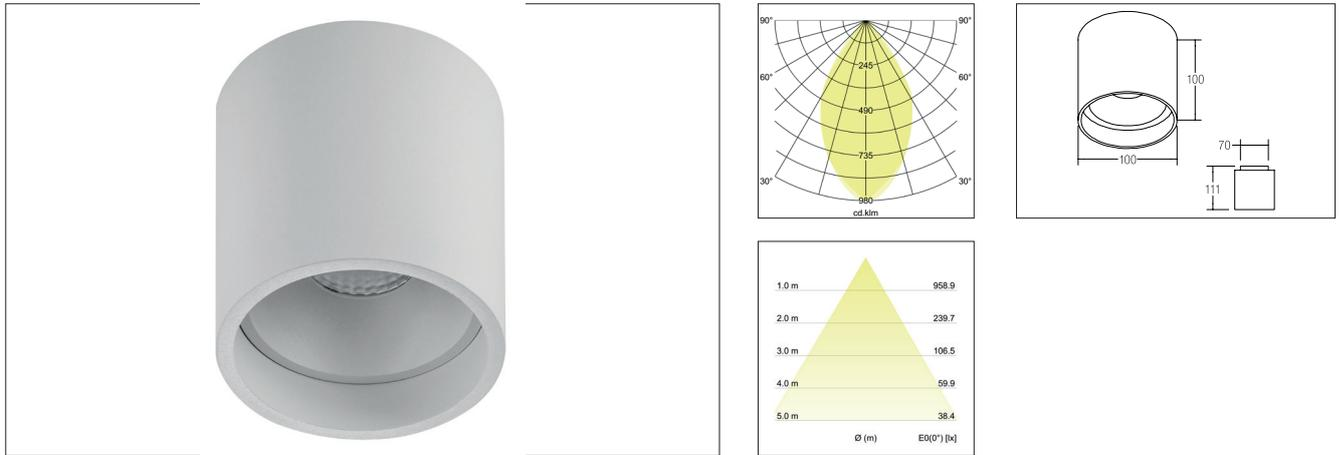
LED-Anbaudownlight, schaltbar, mit Indirektanteil, strukturweiß, rund. Ausführung in kompakter Bauform für die harmonische Implementierung in stimmige, architektonische Raumkonzepte. LED-Deckenanbaudownlight mit 9,5 W / 900 lm direktem und 1,5 W / 150 lm indirektem Lichtanteil.
