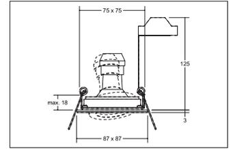
Einbaustrahler, GU10, weiß, quadratisch. Ausgeführt in kompakter Bauform für werkzeuglose Schnellmontage zum Deckeneinbau. Ausführung: GU10, Montageart: Einbaumontage, Montageort: Deckenmontage, Material: Aluminium, Schutzart: nach DIN EN 60529: IP20, Schutzklasse: (EN 61140) II, Spannung: 230V AC 50Hz, Leistung: 50W, Anzahl der Leuchtmittel / Fassungen: 1.0 Stk, Verstellbarkeit: drehbar und schwenkbar, ohne Betriebsgerät, Art der Dimmung: abhängig vom Betriebsgerät .
