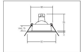
Einbaudownlight, V4A, IP54, GX5,3, weiß, rund. Ausgeführt in kompakter Bauform für werkzeuglose Schnellmontage zum DeckeneinbauAusführung: GX5,3, Montageart: Einbaumontage, Montageort: Deckenmontage, Material: Edelstahl V4A / Glas, Schutzart: nach DIN EN 60529: IP54\*, Schutzklasse: (EN 61140) III, Spannung: 12V, Leistung: 35W, Anzahl der Leuchtmittel / Fassungen: 1.0 Stk, Verstellbarkeit: nicht verstellbar, ohne Betriebsgerät, Art der Dimmung: abhängig vom Betriebsgerät .
