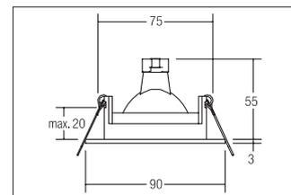
Einbaudownlight, IP65, GX5,3, weiß, rund. Ausgeführt in kompakter Bauform für werkzeuglose Schnellmontage zum Decken-einbauAusführung: GX5,3, Montageart: Einbaumontage, Montageort: Deckenmontage, Material: Aluminium / Glas, Schutzart raumseitig: nach DIN EN 60529: IP65\*, Schutzklasse: (EN 61140) III, Spannung: 12V, Leistung: 35W, Anzahl der Leuchtmittel / Fassungen: 1.0 Stk, Lichtfarbe: weiß, Art der Dimmung: abhängig vom Betriebsgerät .
