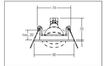
Einbaustrahler, GX5,3, weiß, rund. Ausgeführt in kompakter Bauform für werkzeuglose Schnellmontage zum DeckeneinbauAusführung: GX5,3, Montageart: Einbaumontage, Montageort: Deckenmontage, Material: Aluminium, Schutzart raumseitig: nach DIN EN 60529: IP20, Schutzklasse: (EN 61140) III, Spannung: 12V, Leistung: 50W, Anzahl der Leuchtmittel / Fassungen: 1.0 Stk, Lichtfarbe: weiß, Verstellbarkeit: schwenkbar, Art der Dimmung: abhängig vom Betriebsgerät .
