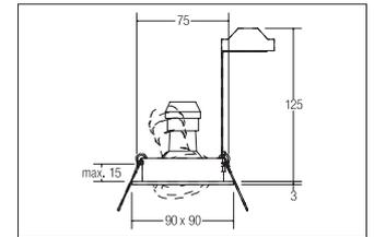
Einbaustrahler, GU10, alu matt, quadratisch. Ausgeführt in kompakter Bauform für werkzeuglose Schnellmontage zum Deckeneinbau. Inkl. Bügel mit GU10-Fassung zur normgerechten Zugentlastung. Ausführung: GU10, Montageart: Einbaumontage, Montageort: Deckenmontage, Material: Aluminium, Schutzart: nach DIN EN 60529: IP20, Schutzklasse: (EN 61140) II, Spannung: 230V AC 50Hz, Leistung: 50W, Anzahl der Leuchtmittel / Fassungen: 1.0 Stk, Verstellbarkeit: schwenkbar, Art der Dimmung: sonstige .
