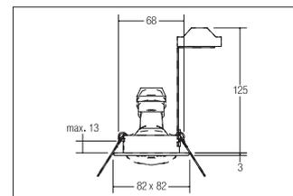
Einbaustrahler, GU10, nickel matt, quadratisch. Ausgeführt in kompakter Bauform für werkzeuglose Schnellmontage zum Deckeneinbau. Inkl. Bügel mit GU10-Fassung zur normgerechten Zugentlastung. Ausführung: GU10, Montageart: Einbaumontage, Montageort: Deckenmontage, Material: Stahl, Schutzart: nach DIN EN 60529: IP20, Schutzklasse: (EN 61140) II, Spannung: 230V AC 50Hz, Leistung: 50W, Anzahl der Leuchtmittel / Fassungen: 1.0 Stk, Verstellbarkeit: schwenkbar, Art der Dimmung: sonstige .
