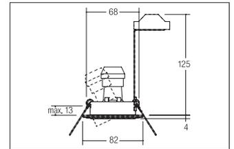
Einbaustrahler, GU10, chrom, rund. Ausgeführt in kompakter Bauform für werkzeuglose Schnellmontage zum Deckeneinbau. Inkl. Bügel mit GU10-Fassung zur normgerechten Zugentlastung. Ausführung: GU10, Montageart: Einbaumontage, Montageort: Deckenmontage, Material: Aluminium, Schutzart: nach DIN EN 60529: IP20, Schutzklasse: (EN 61140) II, Spannung: 230V AC 50Hz, Leistung: 50W, Anzahl der Leuchtmittel / Fassungen: 1.0 Stk, Verstellbarkeit: schwenkbar, Art der Dimmung: sonstige .
