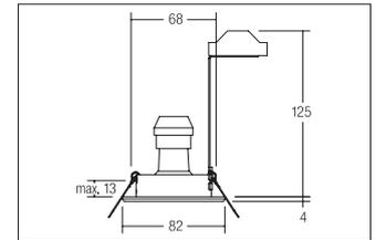
Einbaustrahler, GU10, schwarz, rund. Ausgeführt in kompakter Bauform für werkzeuglose Schnellmontage zum Deckeneinbau. Inkl. Bügel mit GU10-Fassung zur normgerechten Zugentlastung. Ausführung: GU10, Montageart: Einbaumontage, Montageort: Deckenmontage, Material: Stahl / Messing, Schutzart: nach DIN EN 60529: IP20, Schutzklasse: (EN 61140) II, Spannung: 230V AC 50Hz, Leistung: 50W, Anzahl der Leuchtmittel / Fassungen: 1.0 Stk, Verstellbarkeit: schwenkbar, Art der Dimmung: sonstige .
