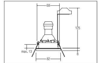
Einbaudownlight, IP65, GU10, weiß, rund. Ausgeführt in kompakter Bauform für werkzeuglose Schnellmontage zum Deckeneinbau. Inkl. Bügel mit GU10-Fassung zur normgerechten Zugentlastung. Ausführung: GU10, Montageart: Einbaumontage, Montageort: Deckenmontage, Material: Guss / Glas, Schutzart: nach DIN EN 60529: IP65\*, Schutzklasse: (EN 61140) II, Spannung: 230V AC 50Hz, Leistung: 50W, Anzahl der Leuchtmittel / Fassungen: 1.0 Stk, Verstellbarkeit: nicht verstellbar, Art der Dimmung: sonstige .
