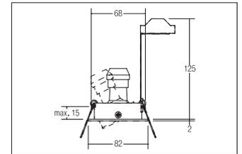
Einbaustrahler, V4A, GU10, edelstahl, rund. Ausgeführt in kompakter Bauform für werkzeuglose Schnellmontage zum Deckeneinbau. Inkl. Bügel mit GU10-Fassung zur normgerechten Zugentlastung. Ausführung: GU10, Montageart: Einbaumontage, Montageort: Deckenmontage, Material: Edelstahl V4A, Schutzart: nach DIN EN 60529: IP20, Schutzklasse: (EN 61140) II, Spannung: 230V AC 50Hz, Leistung: 50W, Anzahl der Leuchtmittel / Fassungen: 1.0 Stk, Verstellbarkeit: schwenkbar, Art der Dimmung: sonstige .
