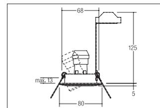
Einbaustrahler, GU10, edelstahl\*, rund. Ausgeführt in kompakter Bauform für werkzeuglose Schnellmontage zum Deckeneinbau. Inkl. Bügel mit GU10-Fassung zur normgerechten Zugentlastung. Ausführung: GU10, Montageart: Einbaumontage, Montageort: Deckenmontage, Material: Stahl, Schutzart: nach DIN EN 60529: IP20, Schutzklasse: (EN 61140) II, Spannung: 230V AC 50Hz, Leistung: 50W, Anzahl der Leuchtmittel / Fassungen: 1.0 Stk, Verstellbarkeit: schwenkbar, Art der Dimmung: sonstige .
