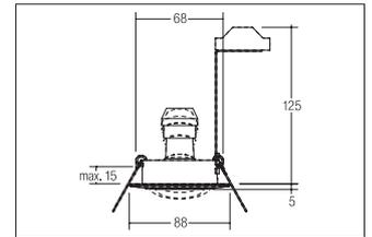
Einbaustrahler, GU10, nickel matt, rund. Ausgeführt in kompakter Bauform für werkzeuglose Schnellmontage zum Deckeneinbau. Inkl. Bügel mit GU10-Fassung zur normgerechten Zugentlastung. Ausführung: GU10, Montageart: Einbaumontage, Montageort: Deckenmontage, Material: Guss, Schutzart: nach DIN EN 60529: IP20, Schutzklasse: (EN 61140) II, Spannung: 230V AC 50Hz, Leistung: 50W, Anzahl der Leuchtmittel / Fassungen: 1.0 Stk, Verstellbarkeit: schwenkbar, Art der Dimmung: sonstige .
