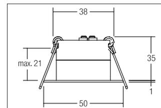
LED-Lichtpunkt, IP44, chrom, rund. Ausgeführt in kompakter Bauform für werkzeuglose Schnellmontage zum Deckeneinbau-
