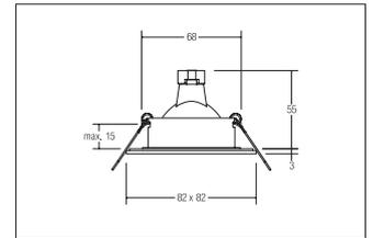
Einbaudownlight, V4A, IP54, GX5,3, edelstahl, quadratisch. Ausgeführt in kompakter Bauform für werkzeuglose Schnellmontage zum Deckeneinbau. Ausführung: GX5,3, Montageart: Einbaumontage, Montageort: Deckenmontage, Material: Edelstahl V4A / Glas, Schutzart: nach DIN EN 60529: IP54\*, Schutzklasse: (EN 61140) III, Spannung: 12V, Leistung: 35W, Anzahl der Leuchtmittel / Fassungen: 1.0 Stk, Verstellbarkeit: nicht verstellbar, ohne Betriebsgerät, Art der Dimmung: abhängig vom Betriebsgerät .
