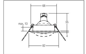
Einbaustrahler, GX5,3, nickel matt, rund. Ausgeführt in kompakter Bauform für werkzeuglose Schnellmontage zum Deckeneinbau
