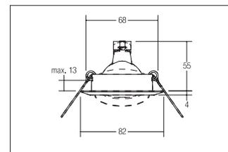
Einbaustrahler, GX5,3, chrom, rund. Ausgeführt in kompakter Bauform für werkzeuglose Schnellmontage zum Deckeneinbau-
