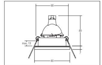
Einbaudownlight, IP65, GX5,3, chrom, rund. Ausgeführt in kompakter Bauform für werkzeuglose Schnellmontage zum Deckeneinbau. Ausführung: GX5,3, Montageart: Einbaumontage, Montageort: Deckenmontage, Material: Guss / Glas, Schutzart: nach DIN EN 60529: IP65\*, Schutzklasse: (EN 61140) III, Spannung: 12V, Leistung: 50W, Anzahl der Leuchtmittel / Fassungen: 1.0 Stk, Verstellbarkeit: nicht verstellbar, ohne Betriebsgerät, Art der Dimmung: abhängig vom Betriebsgerät .
