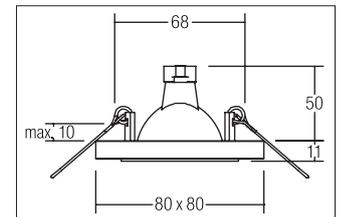
Einbaudownlight, GX5,3, chrom, quadratisch. Ausgeführt in kompakter Bauform für werkzeuglose Schnellmontage zum Deckeneinbau. Ausführung: GX5,3, Montageart: Einbaumontage, Montageort: Deckenmontage, Material: Aluminiumguss / Glas, Schutzart: nach DIN EN 60529: IP20, Schutzklasse: (EN 61140) III, Spannung: 12V, Leistung: 50W, Anzahl der Leuchtmittel / Fassungen: 1.0 Stk, Verstellbarkeit: nicht verstellbar, ohne Betriebsgerät, Art der Dimmung: abhängig vom Betriebsgerät .
