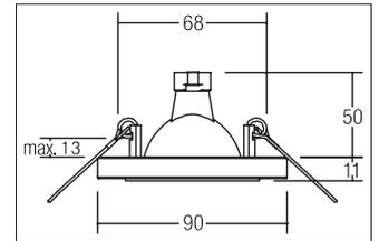
Einbaudownlight, GX5,3, chrom, rund. Ausgeführt in kompakter Bauform für werkzeuglose Schnellmontage zum Deckeneinbau-
