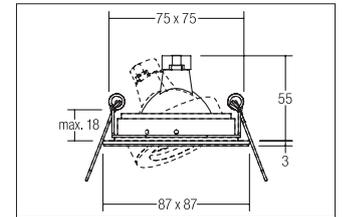
Einbaustrahler, GX5,3, alu matt, quadratisch. Ausgeführt in kompakter Bauform für werkzeuglose Schnellmontage zum Decken-einbauAusführung: GX5,3, Montageart: Einbaumontage, Montageort: Deckenmontage, Material: Aluminium, Schutzart: nach DIN EN 60529: IP20, Schutzklasse: (EN 61140) III, Spannung: 12V, Leistung: 50W, Verstellbarkeit: drehbar und schwenkbar, ohne Betriebsgerät, Art der Dimmung: abhängig vom Betriebsgerät .
