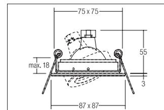
Einbaustrahler, GX5,3, weiß, quadratisch. Ausgeführt in kompakter Bauform für werkzeuglose Schnellmontage zum Deckeneinbau. Ausführung: GX5,3, Montageart: Einbaumontage, Montageort: Deckenmontage, Material: Aluminium, Schutzart: nach DIN EN 60529: IP20, Schutzklasse: (EN 61140) III, Spannung: 12V, Leistung: 50W, Verstellbarkeit: drehbar und schwenkbar, ohne Betriebsgerät, Art der Dimmung: abhängig vom Betriebsgerät .
