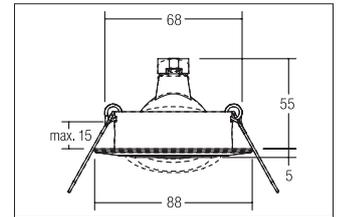
Einbaustrahler, GX5,3, gold, rund. Ausgeführt in kompakter Bauform für werkzeuglose Schnellmontage zum DeckeneinbauAusführung: GX5,3, Montageart: Einbaumontage, Montageort: Deckenmontage, Material: Guss, Schutzart: nach DIN EN 60529: IP20, Schutzklasse: (EN 61140) III, Spannung: 12V, Leistung: 50W, Anzahl der Leuchtmittel / Fassungen: 1.0 Stk, Verstellbarkeit: schwenkbar, ohne Betriebsgerät, Art der Dimmung: abhängig vom Betriebsgerät .
