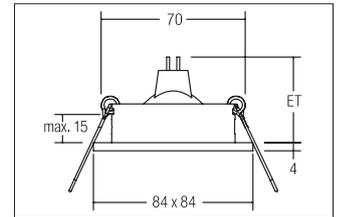
Einbaustrahler, GX5,3, weiß, quadratisch. Ausgeführt in kompakter Bauform für werkzeuglose Schnellmontage zum Deckeneinbau. Ausführung: ohne Fassung, Montageart: Einbaumontage, Montageort: Deckenmontage, Material: Aluminiumguss, Schutzart: nach DIN EN 60529: IP20, Schutzklasse: (EN 61140) III, Spannung: 12V, Leistung: 50W, Anzahl der Leuchtmittel / Fassungen: 1.0 Stk, Verstellbarkeit: schwenkbar, ohne Betriebsgerät, Art der Dimmung: abhängig vom Betriebsgerät .
