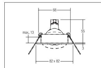
Einbaustrahler, GX5,3, nickel matt, quadratisch. Ausgeführt in kompakter Bauform für werkzeuglose Schnellmontage zum DeckeneinbauAusführung: GX5,3, Montageart: Einbaumontage, Montageort: Deckenmontage, Material: Stahl, Schutzart: nach DIN EN 60529: IP20, Schutzklasse: (EN 61140) III, Spannung: 12V, Leistung: 50W, Anzahl der Leuchtmittel / Fassungen: 1.0 Stk, Verstellbarkeit: schwenkbar, ohne Betriebsgerät, Art der Dimmung: abhängig vom Betriebsgerät .
