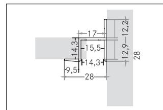
Deckeneinbauprofil mit Wandbefestigung, alu eloxiert. Material: Aluminium, Abmessung Profil: L: 100 mm x B: 28 mm x H: 28 mm.
