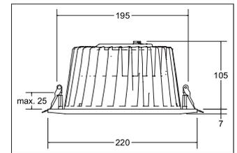
LED-Einbaudownlight, DALI dimmbar, weiss, rund. Ausgeführt in kompakter Bauform für werkzeuglose Schnellmontage zum Deckeneinbau Montageart: Einbaumontage, Montageort: Deckenmontage, Material: Aluminium / Glas / Kunststoff, Schutzart: nach DIN EN 60529: IP20, Schutzklasse: (EN 61140) II, Spannung: 230V AC 50Hz, Leistung: 36.3W, Anzahl der Leuchtmittel / Fassungen: 1.0 Stk, Lichtfarbe: weiß, Abstrahlwinkel: 45°, Verstellbarkeit: nicht verstellbar, mit Betriebsgerät, Art der Dimmung: DALI .
