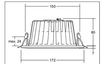
LED-Einbaudownlight, schaltbar, weiss, rund. Ausgeführt in kompakter Bauform für werkzeuglose Schnellmontage zum Decken-einbau Montageart: Einbaumontage, Montageort: Deckenmontage, Material: Aluminium / Glas / Kunststoff, Schutzart: nach DIN EN 60529: IP20, Schutzklasse: (EN 61140) II, Spannung: 230V AC 50Hz, Leistung: 30W, Anzahl der Leuchtmittel / Fassungen: 1.0 Stk, Lichtfarbe: weiß, Abstrahlwinkel: 40°, Verstellbarkeit: nicht verstellbar, mit Betriebsgerät, Art der Dimmung: schaltbar .
