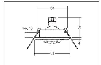
Einbaustrahler, GX5,3, weiß, rund. Ausgeführt in kompakter Bauform für werkzeuglose Schnellmontage zum Deckeneinbau. Ausführung: GX5,3, Montageart: Einbaumontage, Montageort: Deckenmontage, Material: Edelstahl, Schutzart: nach DIN EN 60529: IP20, Schutzklasse: (EN 61140) III, Spannung: 12V, Leistung: 50W, Anzahl der Leuchtmittel / Fassungen: 1.0 Stk, Verstellbarkeit: schwenkbar, ohne Betriebsgerät, Art der Dimmung: abhängig vom Betriebsgerät .
