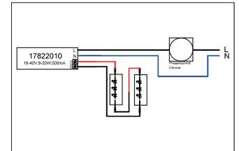
LED-Konverter 500 mA, Phasenabschnitt dimmbar. Dieses Betriebsgerät erfüllt die Anforderungen für Sicherheitsbeleuchtungsanlagen nach DIN EN 50172 VDE 0108-100:2005-01. Dieser Konverter ist durch Sicherungseinrichtungen gegen Überspannung und Kurzschluss sowie thermische und elektrische Überlastung geschützt. Die Eingangs- und die Ausgangsklemme ist für Leitungen mit einem Querschnitt von bis zu 2,5 mm<sup>2</sup> geeignet.
