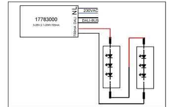
LED-Konverter 700 mA, DALI dimmbar, (digital). Dieser Konverter ist durch Sicherungseinrichtungen gegen Überspannung und Kurzschluss sowie thermische und elektrische Überlastung geschützt. Die Eingangs- und die Ausgangsklemme ist für Leitungen mit einem Querschnitt von 0,75-1,5 mm<sup>2</sup> geeignet. Material: Kunststoff, Schutzart raumseitig: nach DIN EN 60529: IP20, Schutzklasse: (EN 61140) II, Spannung: 230V AC 50Hz , Leistung: 20W, Art der Dimmung: DALI-2.
