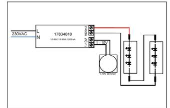
LED-Konverter 1.000 mA, 1-10V dimmbar (analog). Dieser Konverter ist durch Sicherungseinrichtungen gegen Überspannung und Kurzschluss sowie thermische und elektrische Überlastung geschützt. Die Eingangs- und die Ausgangsklemme ist für Leitungen mit einem Querschnitt von 0,75-1,5 mm<sup>2</sup> geeignet. Material: Kunststoff, Schutzart raumseitig: nach DIN EN 60529: IP20, Schutzklasse: (EN 61140) II, Spannung: 230V AC 50Hz, Leistung: 36W, Art der Dimmung: 1-10 V.
