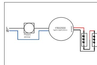
LED-Rundkonverter 350 mA, Phasenabschnitt dimmbar.. Ausführung: Plug&Play, Material: Kunststoff, Schutzart raumseitig: nach DIN EN 60529: IP20, Schutzklasse: (EN 61140) II, Spannung: 230V AC 50Hz, Leistung: 7W, Dimmbar: Ja, Art der Dimmung: Phasenabschnitt.
