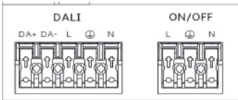
Abb.: Anschlussschema: Dali oder schaltbar
