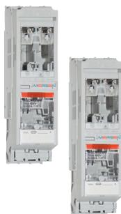
Die Produktpalette der MULTIBLOC® 000.RST8 umfasst NH-Sicherungs-Lasttrennschalter für 100 A. Die Produkte sind in 3-poliger Ausführung verfügbar und sind geeignet für 40 und 60mm Sammelschienen-Systeme.
